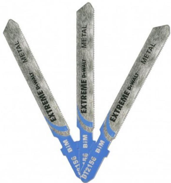
Lames de scie sauteuse Bi-Métal EXTREME offrant une plus grande durabilité dans les métaux non-ferreux et les alliages ferreux. Lubrifiant de fluide de refroidissement recommandé : huile de coupe, émulsion, graisse de lubrification/refroidissement. Pour couper l'aluminium, les métaux ferreux et non-ferreux. Garantie 3 ans.
