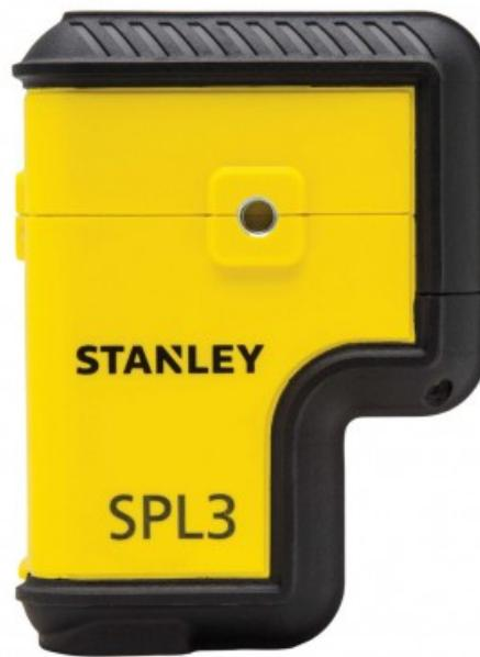
Mise à niveau automatique - Projection de 3 points: 1 en haut et 1 en bas pour l'aplomb vertical et 1 en face à 90°- Portée intérieure de 30 m- Précision +/-3mm@10m (bas) +/-6mm@10m (bas)-Plage de nivellation +/- 4°- Blocage du pendule - Double Filetage 1/4" -Revêtement renforcé- IP50 - Fourni avec le Quick link, bras articulé permettant d'orienter le laser dans tous les sens, piles et étui de transport avec attache ceinture
