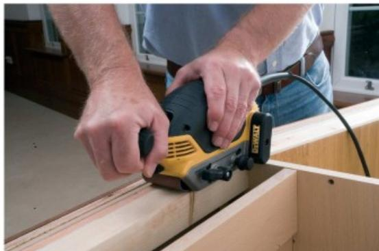
Toile de support souple, classe "J" Grain en oxyde d'aluminium de qualité supérieure pour un enlèvement rapide et efficace de matière et une bonne finition Collage thermorésistant à la résine assure une adhérence excellente des grains Pour tous les travaux de décapage, de ponçage et de finition sur les surfaces en bois, en métal et peintes Garantie 3 ans
