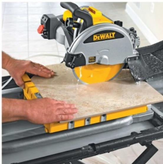
Rebord continu permettant des découpes sans éclat dans les tuiles et carreaux de céramique
