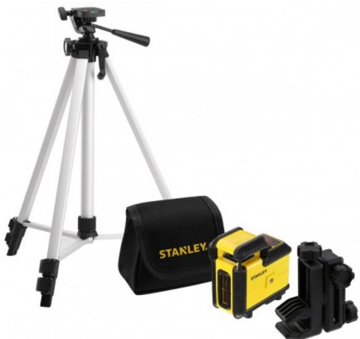
Mise à niveau automatique - Projection d'une ligne horizontale à 360° et une ligne verticale - Plage (diamètre) de 20 m - Précision +/-4mm@10m - Plage de nivellation +/- 4° - Blocage du pendule - Double Filetage 1/4" - Revêtement renforcé - IP50 - Fourni avec le Quick link, bras articulé permettant d'orienter le laser dans tous les sens, piles et étui de transport avec attache ceinture
