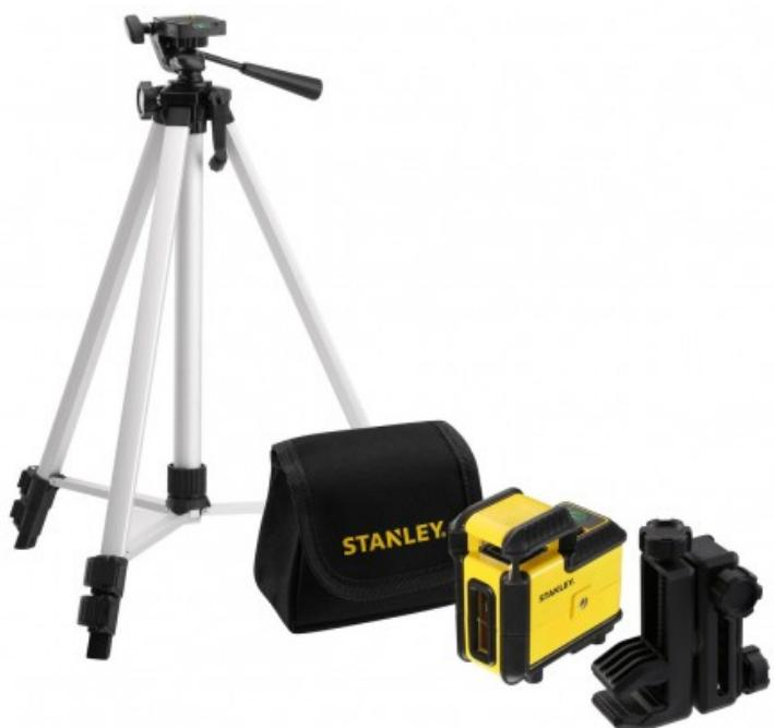
Mise à niveau automatique - Projection d'une ligne horizontale à 360° et une ligne verticale - Plage (diamètre) de 25 m - Précision +/-4mm@10m - Plage de nivellation +/- 4°- Blocage du pendule - Double Filetage 1/4" - Revêtement renforcé - IP50 - Fourni avec le Quick link, bras articulé permettant d'orienter le laser dans tous les sens, piles et étui de transport avec attache ceinture
