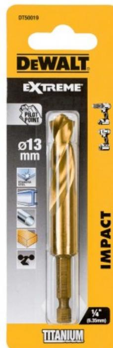
Pour utilisation dans des aciers à alliage et sans alliage présentant une résistance à la rupture jusqu'à 900 N/mm<sup>2</sup>, des tôles métalliques et des matériaux profilés à parois minces dans lesquels un perçage précis et net est capital. Pointe pilote pénétrant le matériau plus rapidement et permettant un perçage précis sur des surfaces incurvées. Revêtement en titane offrant une plus grande résistance à l'usure et à la corrosion et une durée de vie 2 fois plus longue. Garantie 3 ans.
