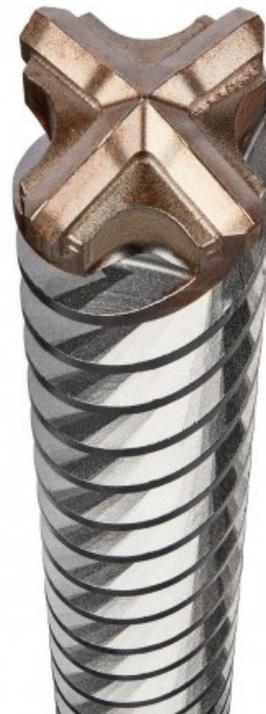
Les forets XLR SDS-Max possèdent une tête en massive en carbure, pour prévenir des cassures et des vibrations. Les quatre hélices permettent une évacuation rapide des débris pour une plus grande efficacité. Pour le perçage de béton armé, de matériaux de maçonnerie, de pierres naturelles et artificielles Perçage dans le béton Garantie 3 ans
