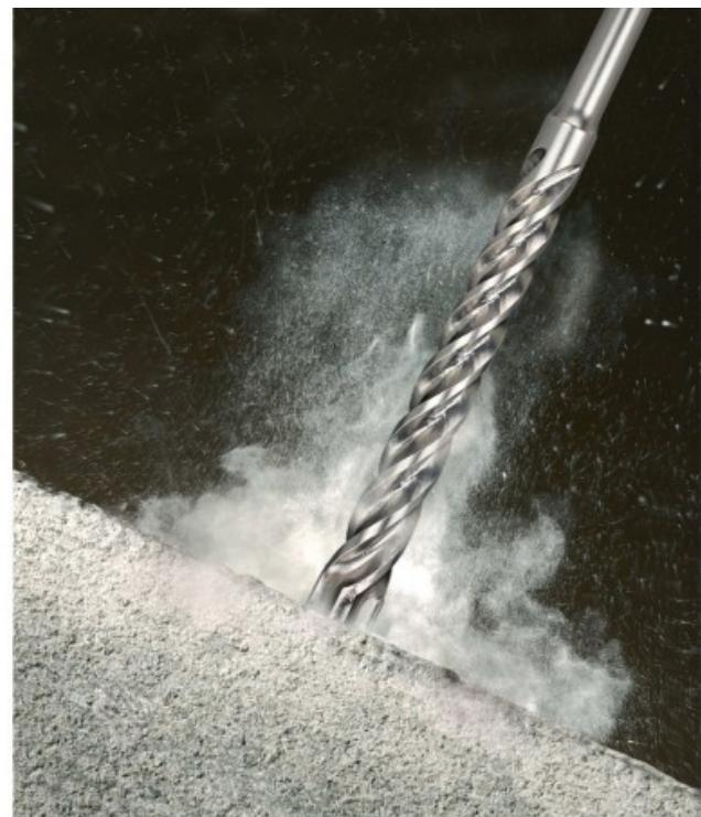
La gamme de forets SDS-Plus XLR possède 4 taillants en carbure pour une plus grande résistance et pour réduire les vibrations. Les quatres hélices permettent une meilleure évacuation des débris pour un perçage plus rapide. Garantie 3 ans
