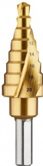
Les forets étagés EXTREME® ont une flûte à double spirale pour une meilleure évacuation des débris . Inscription des diamètres au laser. Adapté pour les perçuseuse classique et à emmanchement impact. Agrandit les trousAdapté pour l'acier, les métaux ferreux et non ferreux, ainsi que le plastique.Pour le perçage dans le métal de 6mm à 20mm. Garantie 3 ans
