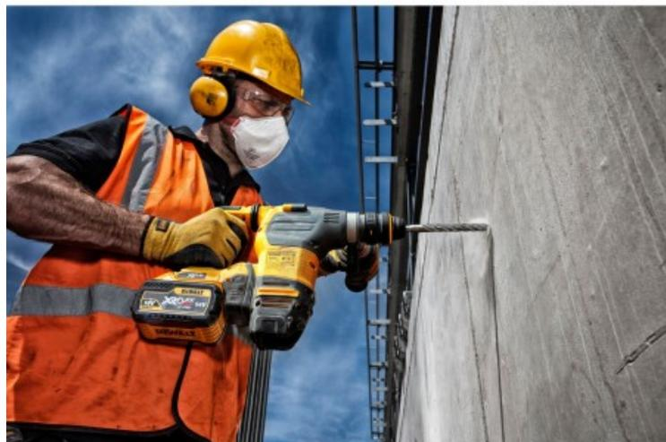
Les forets SDS-Plus EXTREME possèdent deux taillants en carbure pour un perçage rapide et efficace. Les quatre hélices permettent une évacuation rapide des débris pour un perçage optimale. Convient au perçage rapide de trous de vidange, d'ancrage ou dégagement dans des matériaux de maçonnerie, la pierre, le béton et la brique/parpaing
