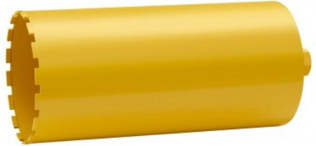
Wet Diamond Core Drills. Optimised diamond segment design allows the combination of high drilling speeds and long tool path in a variety of materials Raccord 1 1/4" UNC femelle universel pour carotteuses DEWALT et autres marquesLe diamant permet de percer plus vite et d'avoir une meilleure durée de vieLa soudure au laser permet d'éviter les rupturesPour tout types de bétonA utiliser avec carroteuse à eau Garantie 3 ans
