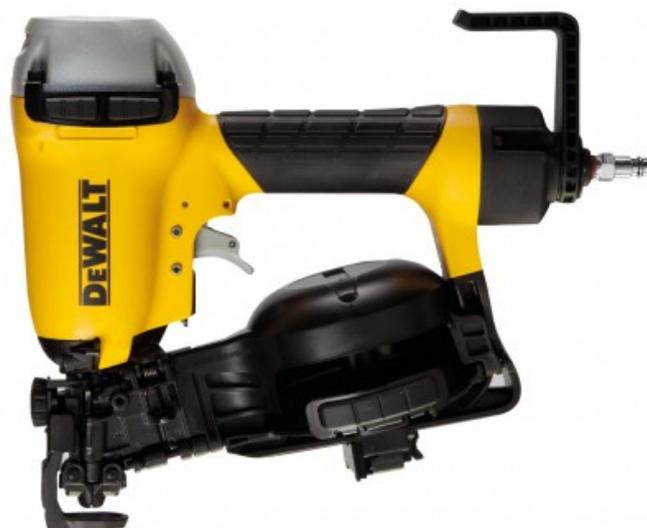
Cloueur pneumatique pour toiture compact avec une bonne prise en main - Poignée en caoutchouc confortable - Mors de positionnement des pointes pour une meilleure qualité de clouage - Ajustement de la profondeur d'enfoncement des pointes - Protections du cadre latéral pour une durée de vie améliorée -
