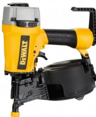
Cloueur de bardage conçu pour fixer des clous jusqu'à 64 mm dans les bois les plus durs - Mode rafale et coup par coup pour plus de précision - Magasin ajustable pour différentes tailles de clous - Échappement à 360° - Application pneumatique fonctionnant à des températures entre -20° et 50° avec un entretien minimal - Réglage de la profondeur -
