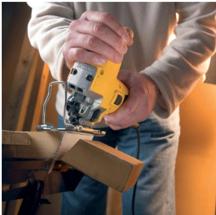
La vitesse variable, grâce à la molette et à l'interrupteur, permet de couper des matériaux très variés
