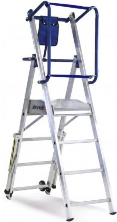
Plateforme aluminium Pir Légère 3 marches. Garde corps protégeant l'utilisateur des 4 côtés. Grande plateforme de sécurité avec rebords. Patins caoutchouc antidérapants. Sacoche à outils inclus et roues fixé à la base pour le transport. Sangle anti-ouverture avec crochet et échelle autostable debout une fois repliée. Stabilisateurs télescopiques repliable le long de la base.
