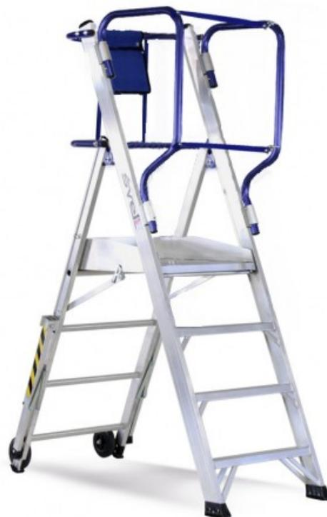
Plateforme aluminium Pir 4 marches. Garde corps protégeant l'utilisateur des 4 côtés. Grande plateforme de sécurité avec rebords. Patins caoutchouc antidérapants. Sacoche à outils inclus et roues. Stabilisateur télescopique. Sangle anti-ouverture avec crochet et échelle autostable debout une fois repliée.
