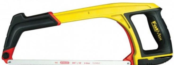
Poignée revolver et repose doigt bimatière - 2 angles de coupe possibles : 45° (coupe à ras) et 90° (coupe standard) - Démontable en 5 configurations d'archer - Jusqu'à 120 mm de capacité de coupe - Tension de la lame réglable jusqu'à 150kg - Livrée avec une lame bimétal 300mm, 10 dents par cm + une lame de scie sabre (type scie à guichet)
