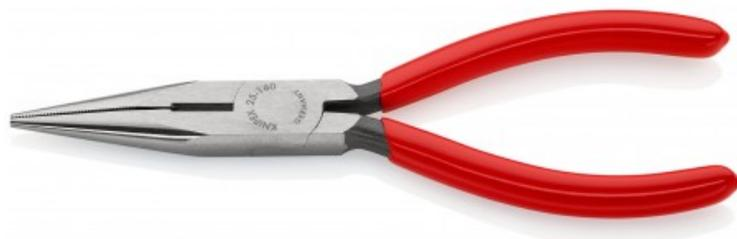
Convient pour les travaux nécessitant une prise et une coupe de précision. Mâchoires demi-rondes, longues et effilées. Intérieur des mâchoires strié. Avec tranchants pour fils doux, mi-durs et durs. Tranchants trempés par induction, dureté d'env. 61 HRC. Acier électrique au vanadium, forgé, trempé à l'huile en plusieurs phases.
