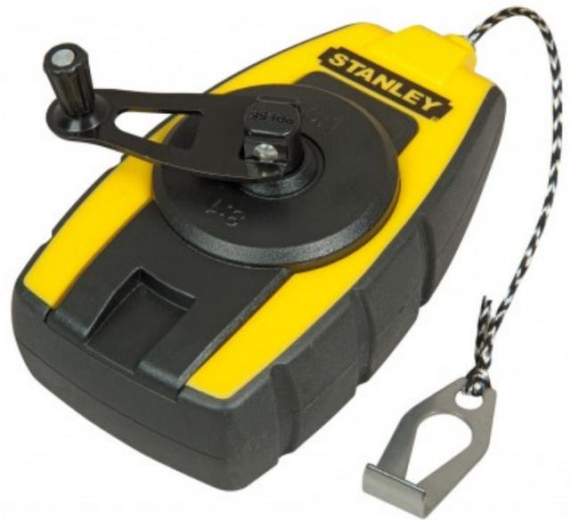
Ligne de précision de 9M - Taille réduite de moitié par rapport à un cordeau traditionnel - Système d'ouverture glissière pour la poudre - Capacité de 28g de poudre - Ratio de rembobinage du fil 3 :1. - Corps en ABS antichocs - Manivelle ergonomique soft grip
