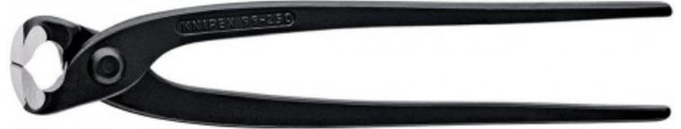
Pour torsader et couper des fils à ligaturer en bobine en une seule opération: rapide, fiable et économique. Tranchants trempés, dureté d'env. 61 HRC. Acier à outils de qualité spéciale, forgé, trempé à l'huile en plusieurs phases.
