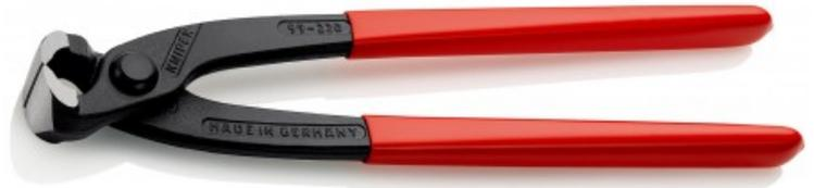
Pour torsader et couper des fils à ligaturer en bobine en une seule opération: rapide, fiable et économique. Tranchants trempés, dureté d'env. 61 HRC. Acier à outils de qualité spéciale, forgé, trempé à l'huile en plusieurs phases.
