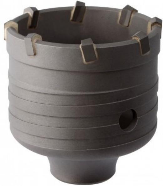
Trépan carbure pour marteau perforateur SDS-plus. Permet de percer des trous non traversant dans des matériaux pleins ou creux. Convient pour la pose de boîtier électrique. S'utilise avec le porte trépan Diager connexion M16.
