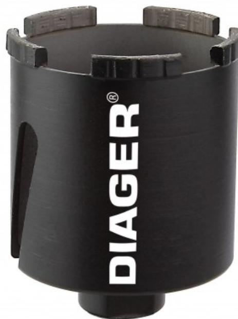
Trépans diamant longueur utile 66 mm, pour le perçage à sec dans la brique et le parpaing. Utilisation en rotation uniquement, ne pas mettre le mode percussion.
