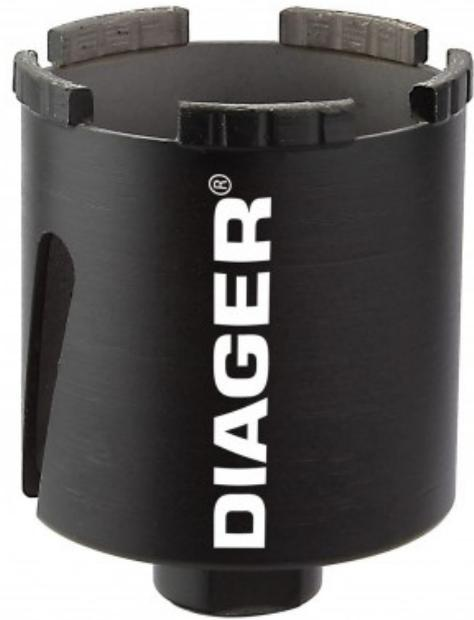
Trépans diamant longueur utile 66 mm, pour le perçage à sec dans la brique et le parpaing. Utilisation en rotation uniquement, ne pas mettre le mode percussion.
