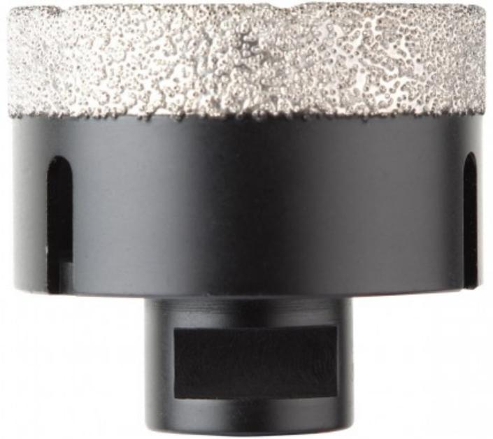
Scie trépan composée de poussière de diamant de qualité premium pour une coupe propre rapide et précise, adaptée pour meuleuse via un alésage M14 ou sur perceuse et perforateur via un emmanchement HEX 8,5 et SDS-plus grâce au système OneHand.
