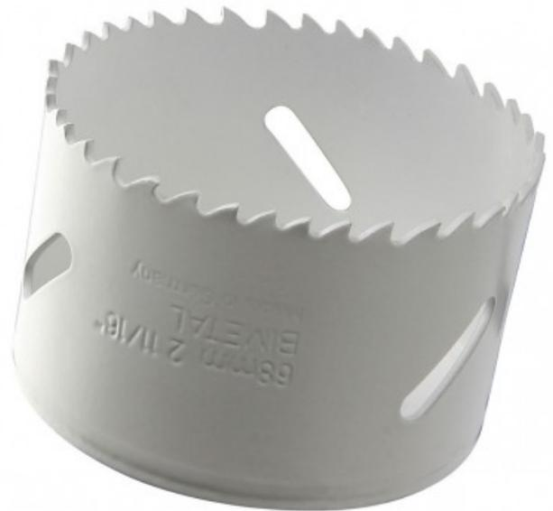
Scie cloche bi-métal 8% de cobalt procure une meilleure résistance dans le perçage des aciers durs comme l'inox. La denture variable permet une polyvalence de coupe dans les matériaux avec un bon niveau de finition (bois, métal, PVC et Inox).
