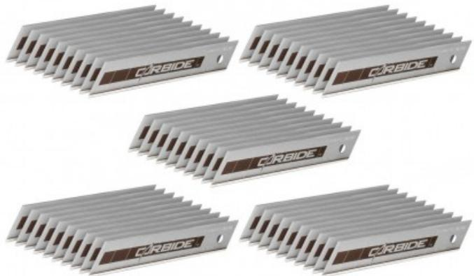
Amélioration de la durabilité de la lame: le tranchant dure 10 fois plus longtemps que les lames classiques. Une couche de Carbure de Tungstène est déposée par un laser haute puissance sur le tranchant de la lame pour en améliorer sa résistance à l'abrasion. Le Carbure de Tungstène est le matériau le plus dur et le plus durable après le diamant. Seul le tranchant est recouvert, ce qui laisse à la lame une bonne flexibilité
