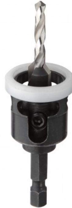
Outil spécial pour la pose de terrasse, l'outil permet de réaliser en une opération un avant trou et le fraisage pour loger la tête de vis. La butée de profondeur est réglable, une bague nylon évite de marquer les lames de terrasse. Ce système garantit un perçage et fraisage constant à la même profon
