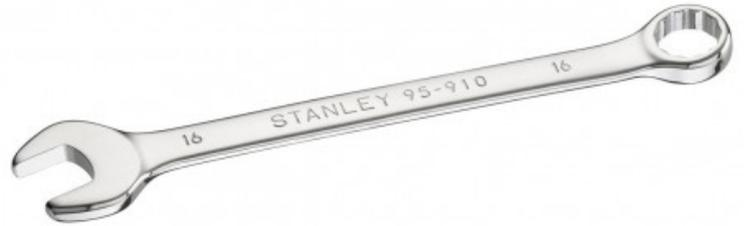
Fourche orientée à 15° - Œil 12 pans orienté à 15° pour les accès de côté - Manche ergonomique pour un plus grand confort et permettant un serrage plus puissant - Finition Chromée contre la corrosion - Acier forgé à froid
