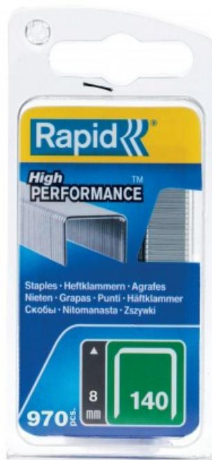
longueur de jambe 8 mm. Pour R44, R64, R14, R34, MS840, Alu 740, R11, R211, R54, E-Tac, CSN140, ESN114. Fil galvanisé. Fil plat, large, pour un meilleur maintien des matériaux fins. Fil robuste haute performance. Jambes à coupe de précision pour une meilleure pénétration. Applications : isolation, tissus et plastiques minces, etc. Emballage double coque, 1290 pcs.
