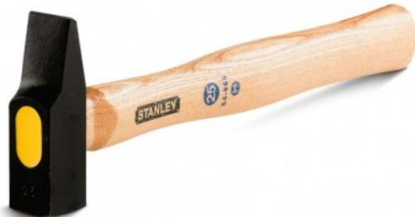
Manche en frêne de haute qualité - Emmanchement en force associé à une résine de collage et d'étanchéité - Panne bombée en acier forgé pour : travaux mécaniques - constructions métalliques - dressage de profilés
