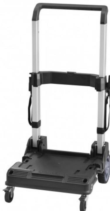
Capacité charge sur surface plane 100kg-50 kg en utilisant les escaliers Roues de devant Ø 75 mm inclus mécanisme arrêt-Roues Ø 180 mm Ceinture de sécurité pour assurer les éléments PRO-STACK™ Poignée télescopique et pliable en aluminium
