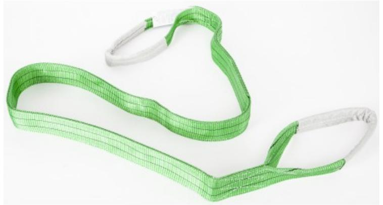
Voici une élingue de polyester pouvant être utilisée pour plusieurs choses : Attacher nos treuils à un point d'ancrage. Dans ce cas, elle sera utilisée en type panier (U). Attacher une poulie à un arbre ou un poteau, alors, elle sera utilisée en étrangleur. Tirer un véhicule à l'aide d'un autre véhicule. Ici, vous l'utiliserez en ligne droite.
