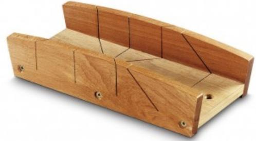
En hêtre traité, Construction collée et vissée pour une meilleure solidité, Idéal pour coupe de plinthes jusqu'à 120mm inclus
