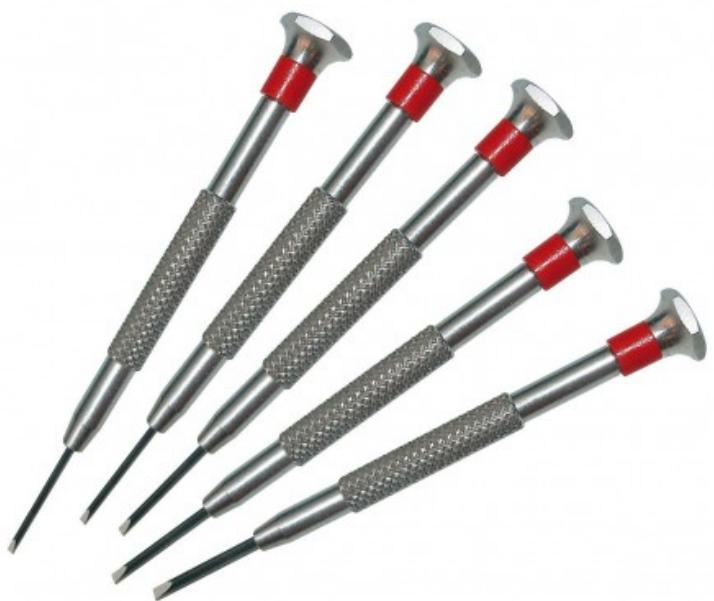
Modèle professionnel pour horlogerie, électronique, corps en laiton nickelé, repose doigt pivotant, centre de la poignée striée/ crantée pour un meilleur contrôle, contient 5 pièces: fente: 0,08 - 1,0 - 1,2 - 1,6 - 2,0mm
