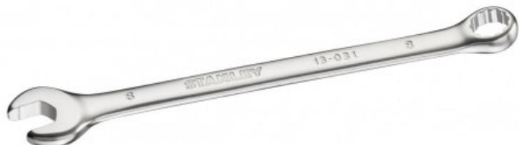
Fourche orientée à 15°. Système « anti slip » sur la fourche. Améliore l'adhérence de la fourche sur la tête de vis. Prise de l'écrou sur 3 points. Œil 12 pans orienté à 15° pour les accès de côté. Finition chrome mat pour une meilleure résistance à la corrosion.
