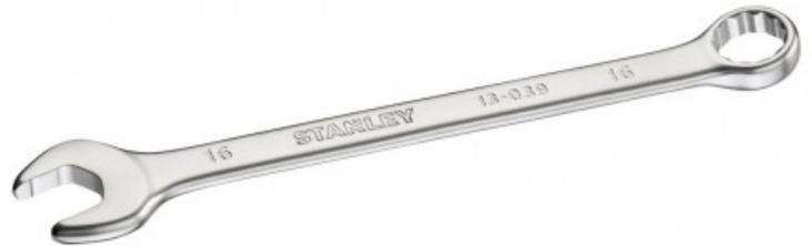
Fourche orientée à 15°- Système « anti slip » sur la fourche - Améliore l'adhérence de la fourche sur la tête de vis - Prise de l'écrou sur 3 points - Œil 12 pans orienté à 15° pour les accès de côté -Finition chrome mat pour une meilleure résistance à la corrosion
