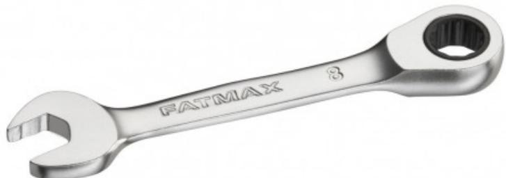
Fourche orientée à 15°- Système « anti slip » sur la fourche - Améliore l'adhérence de la fourche sur la tête de vis - Prise de l'écrou sur 3 points - Øil orienté à 15° pour les accès de côté -Finition chrome mat pour une meilleure résistance à la corrosion - Mécanisme à cliquet pour ne pas avoir à repositionner la clé et gagner du temps-72 dents pour un angle de reprise 5 ° pour travailler dans zone exigüe
