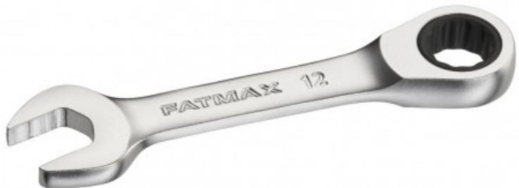
Fourche orientée à 15°- Système « anti slip » sur la fourche - Améliore l'adhérence de la fourche sur la tête de vis - Prise de l'écrou sur 3 points - Øil orienté à 15° pour les accès de côté - Finition chrome mat pour une meilleure résistance à la corrosion - Mécanisme à cliquet pour ne pas avoir à repositionner la clé et gagner du temps-72 dents pour un angle de reprise 5 ° pour travailler dans zone exigüe
