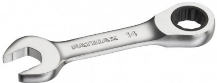
Fourche orientée à 15°- Système « anti slip » sur la fourche - Améliore l'adhérence de la fourche sur la tête de vis - Prise de l'écrou sur 3 points - Øil orienté à 15° pour les accès de côté - Finition chrome mat pour une meilleure résistance à la corrosion - Mécanisme à cliquet pour ne pas avoir à repositionner la clé et gagner du temps-72 dents pour un angle de reprise 5 ° pour travailler dans zone exigüe
