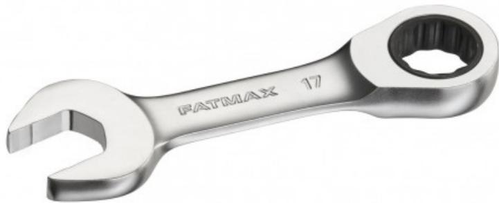
Fourche orientée à 15°- Système « anti slip » sur la fourche - Améliore l'adhérence de la fourche sur la tête de vis - Prise de l'écrou sur 3 points - Øil orienté à 15° pour les accès de côté - Finition chrome mat pour une meilleure résistance à la corrosion - Mécanisme à cliquet pour ne pas avoir à repositionner la clé et gagner du temps-72 dents pour un angle de reprise 5 ° pour travailler dans zone exigüe
